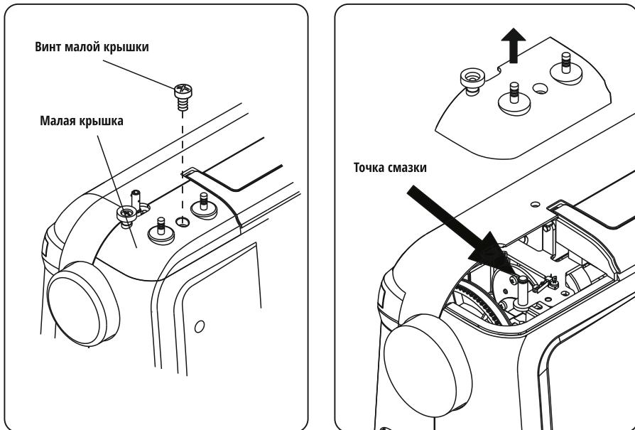
При смазывании, закапайте несколько капель машинного масла высокого качества в точках, обозначенных стрелками на рисунках.
