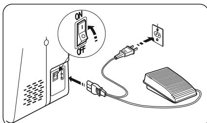
Скорость шитья регулируется нажатием педали. Чем сильнее вы нажимаете на элемент управления, тем быстрее машина работает.
