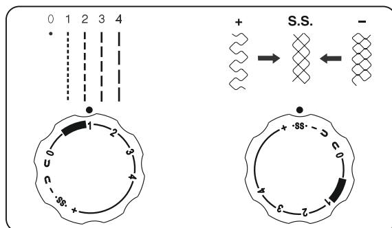
При шитье установите длину стежка на шкале на отметке «S.S.».
