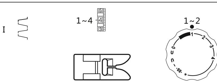
Используйте данный шов для тяжелого прокладочного материала. Положите внахлестку два ряда кромок и, применяя этот вид, соедините их.
