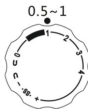
Проложите ряд стежков и отрегулируйте натяжение нити так, чтобы верхняя нить появлялась на обратной стороне ткани. Для получения наилучшего результата, проверьте стежок на отрезке обрабатываемой ткани.
