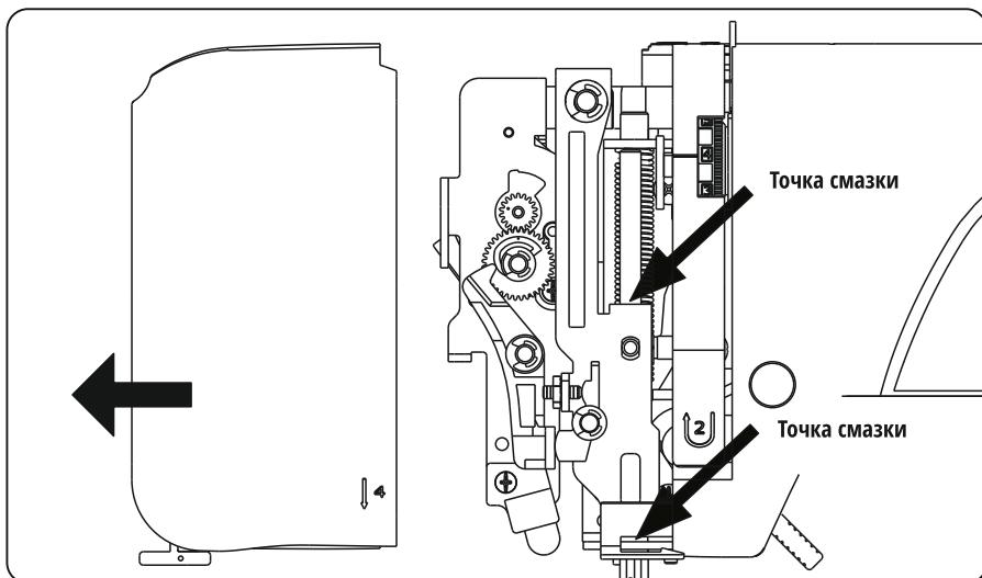
При смазывании, закапайте несколько капель машинного масла высокого качества в точках, обозначенных стрелками на рисунке.
