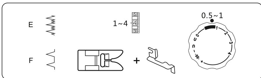
Сложите ткань как показано на рисунке. Опустите прижимную лапку, затем ослабьте винт держателя лапки, чтобы поместить направляющую подогнутого среза между винтом и корпусом держателя лапки. Затяните винт, убедившись, что стенка направляющей подогнутого среза помещена посередине между зубьями прижимной лапки.
