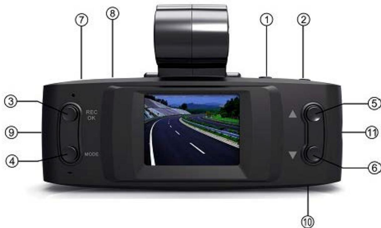
1. **ON/OFF** Кнопка включения/выключения прибора
