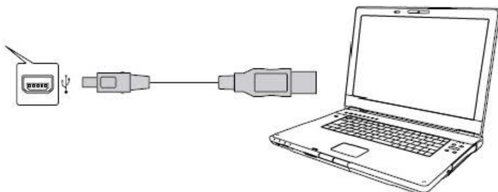
Соедините видео регистратор с компьютером с помощью кабеля USB. Включите прибор, выберите режим **memogu** (накопитель) и нажмите кнопку **OK**. Тогда в папке *Мой компьютер* вы обнаружите новый внешний диск, где будут сохранены все видеозаписи и снимки, сделанные с помощью видео регистратора.
