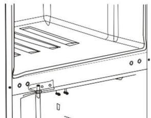
9. Установите верхнюю дверь. Затем установите верхнюю петлю, не фиксируя её. Отрегулируйте дверь, обеспечив её плотное прилегание. Зафиксируйте петлю.
