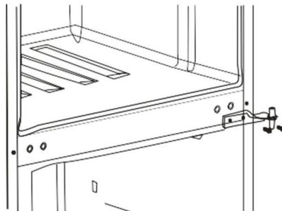
5. Снимите декоративные заглушки, закрывающие отверстия для установки средней петли и переустановите их в соответствии с схемой.
