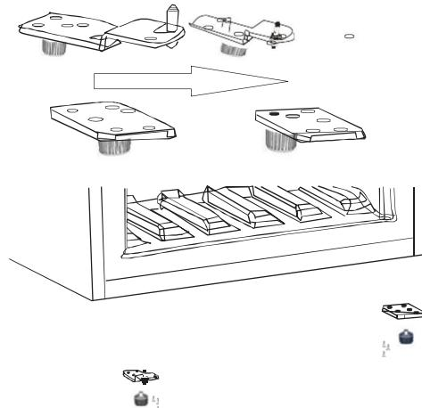
8. Установите нижнюю дверь. Установите среднюю петлю и отрегулировав нижнюю дверь зафиксируйте петлю.
