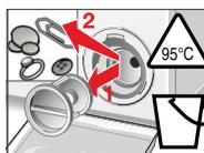
4. Осторожно отвинтите крышку насоса. Прочистите насос внутри, резьбу крышки насоса и корпус насоса (лопастное колесо насоса для стирального раствора должно свободно вращаться).
