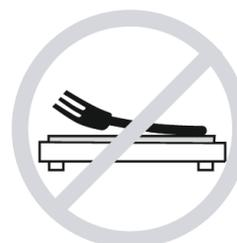
Во избежание нагревания не помещайте на работающую варочную поверхность металлические приборы (ножи, ложки, вилки).
