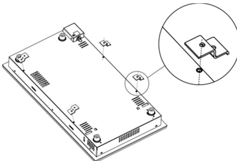
Отрегулируйте положение кронштейна, в зависимости от толщины рабочей поверхности.
