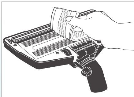
**Очистка чувствительных полов с твердыми покрытиями насадкой для паркетных полов AQUA Stealth\***
