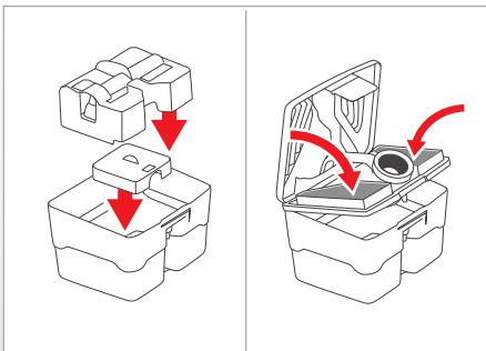
Если был снят всасывающий фильтр, то его необходимо установить в резервуар грязной воды.
