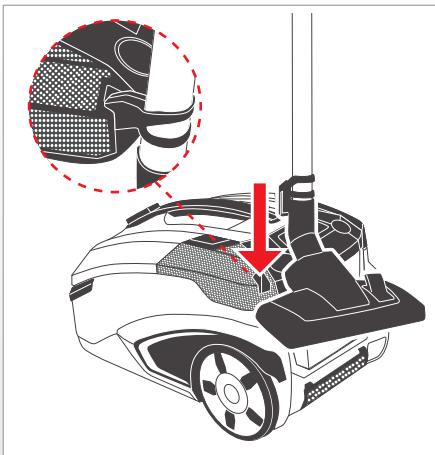
Для крепления всасывающей трубы на приборе использовать парковочное устройство, расположенное на телескопической трубе.
