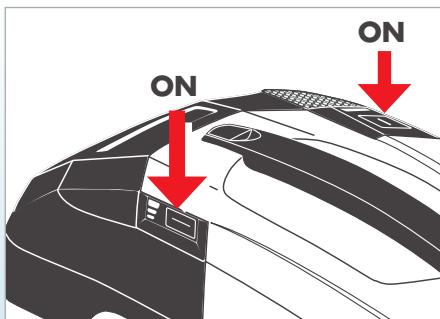
Включить прибор и выбрать требуемый уровень мощности. При влажной уборке рекомендуется для уменьшения остаточной влажности производить уборку на максимальной мощности всасывания, то есть индикатор должен показывать 2 зеленых, 1 красный.
