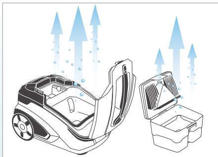
После каждого использования очищать и высушивать аквафильтр, использовавшиеся насадки, а также корпус прибора.
