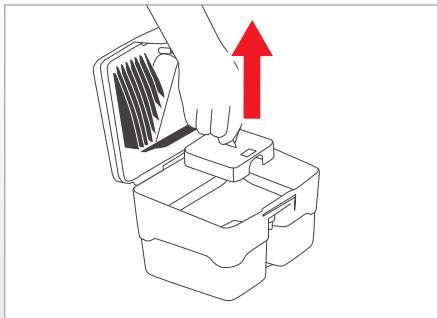
Если в резервуаре для грязной воды аквафильтра еще имеется грязь, то тщательно очистить под струей воды и вылить грязную воду через сливное отверстие.
