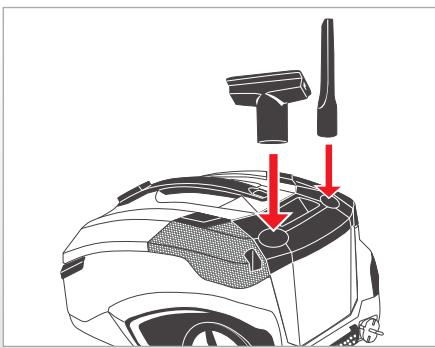
Для того, чтобы всегда иметь принадлежности моющего пылесоса под рукой, можно для хранения вставить насадки в кронштейны, расположенные в крышке резервуара для чистой воды.
