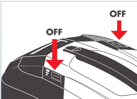
Если закончилась вода в резервуаре для чистой воды, а также для завершения уборки следует сначала выключить насос кратким нажатием на кнопку насоса. Затем выключить прибор кратким нажатием главного выключателя.
