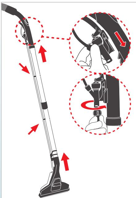
Присоединить телескопическую трубу с подходящей стороны к рукоятке всасывающего шланга, а насадку для влажной уборки пола - к телескопической трубе.
