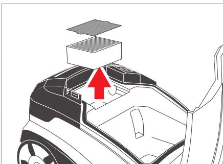
**Очистка специального гигиенического фильтра и специального гигиенического фильтра предварительной очистки**
